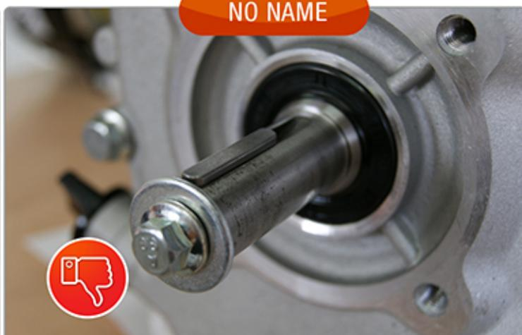
ВЫХОДНОЙ ВАЛ В ОСНОВНОМ ИЗ ЛОМКОГО ЧУГУНА
